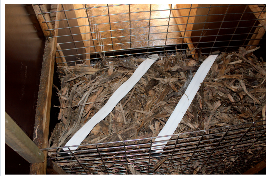
Abb. 2: TDR-System TAUPE im Wurzelholz im Testkanal
