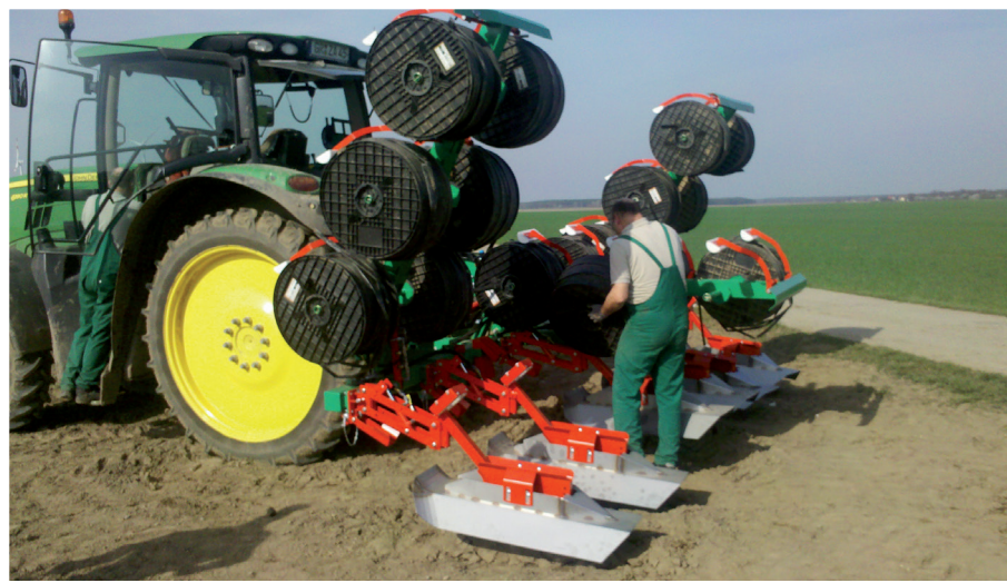
Abbildung 1: 6-reihiges Verlegegerät für Tropfschläuche mit hydraulisch absenkbaaren Magazinhaltern
