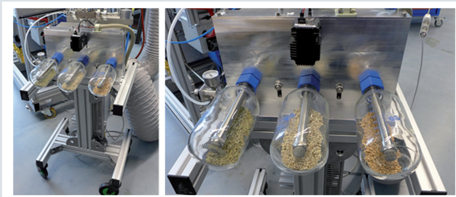
Abb. 2: Fotos der neuen Laboranlage „TriBo“ zur indirekten Plasmabehandlung von trockenen Schüttgütern.
