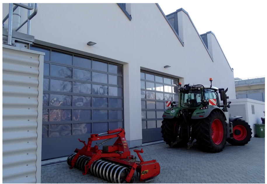
Abb. 3: Versuchsfahrzeug beim automatisierten Ankoppeln an ein Anbaugerät
