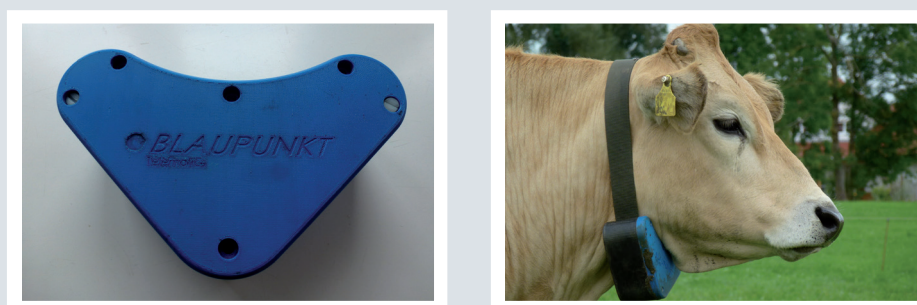
Abb. 1: Gehäuseprototyp des GPS-GSM Ortungssystems für Rinder der Firma Blaupunkt Telematics
