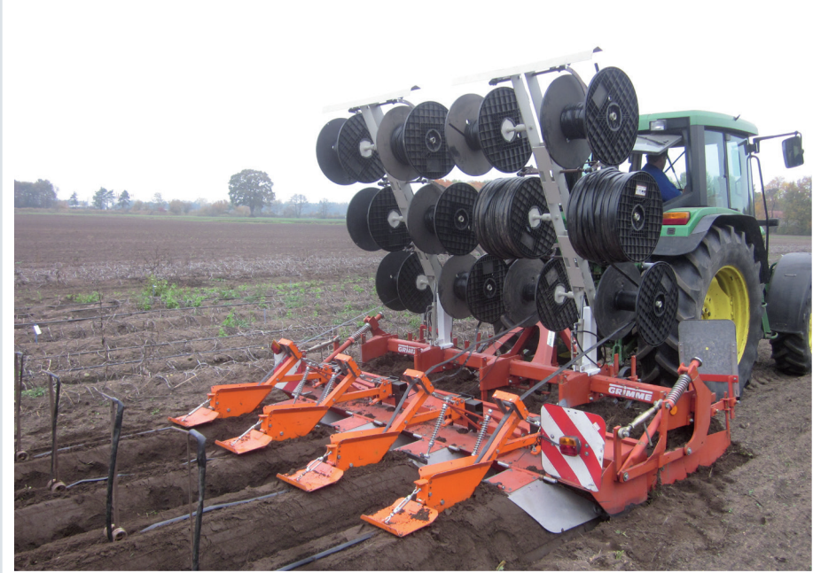
Abbildung 2: Auf herkömmlichem Häufelgerät installierte hydraulisch klappbare Magazinhalter
