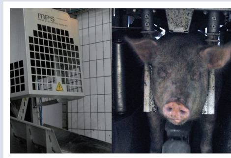
Abb. 2: vollautomatische Elektrobetäubung am Beispiel der Midas-Anlage
