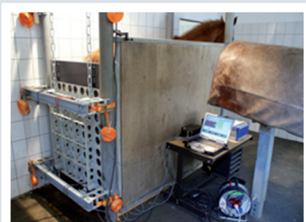
Abb. 1: Bei Schlagprüfung geborstene Ausfachungsbohle aus Bilinga ( Nauclea diderrichii ) (Foto: Thünen-Institut).
