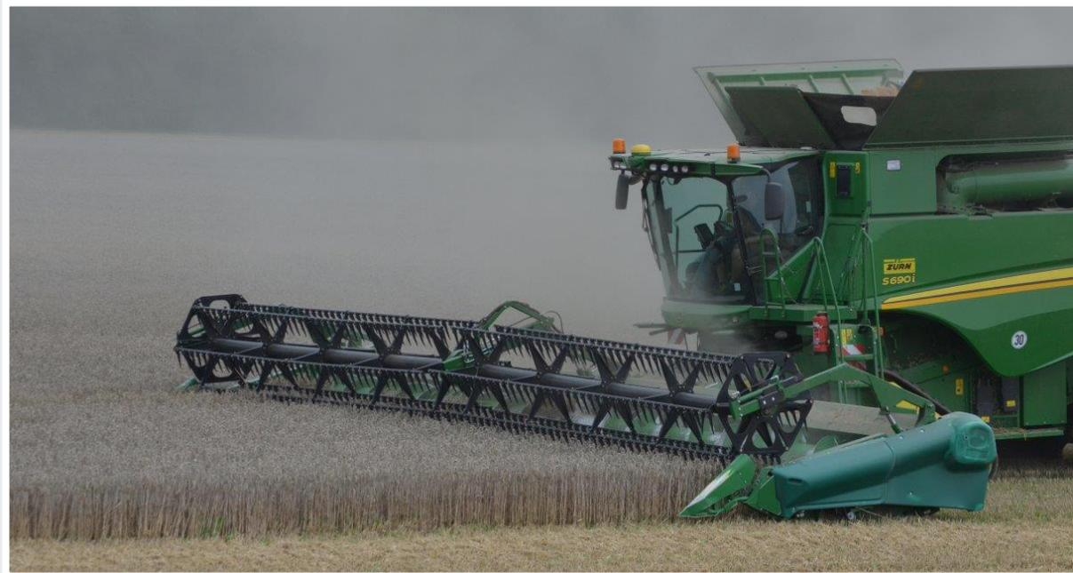
Abb. 3: Schneidwerk während Feldversuche (hier konventionelles Zürn Schneidwerk, 40 ft)
