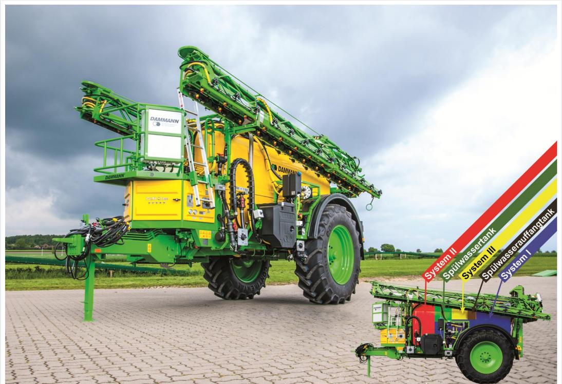
Abb. 1: Prototyp Feldspritzgerät mit Direkteinspeisung ohne Verzögerungszeiten
