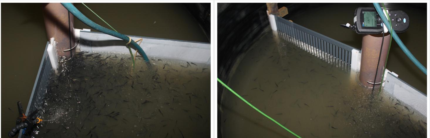
Abb. 1: Sortierversuche über horizontal stehende Stabgitter im Räumbecken
