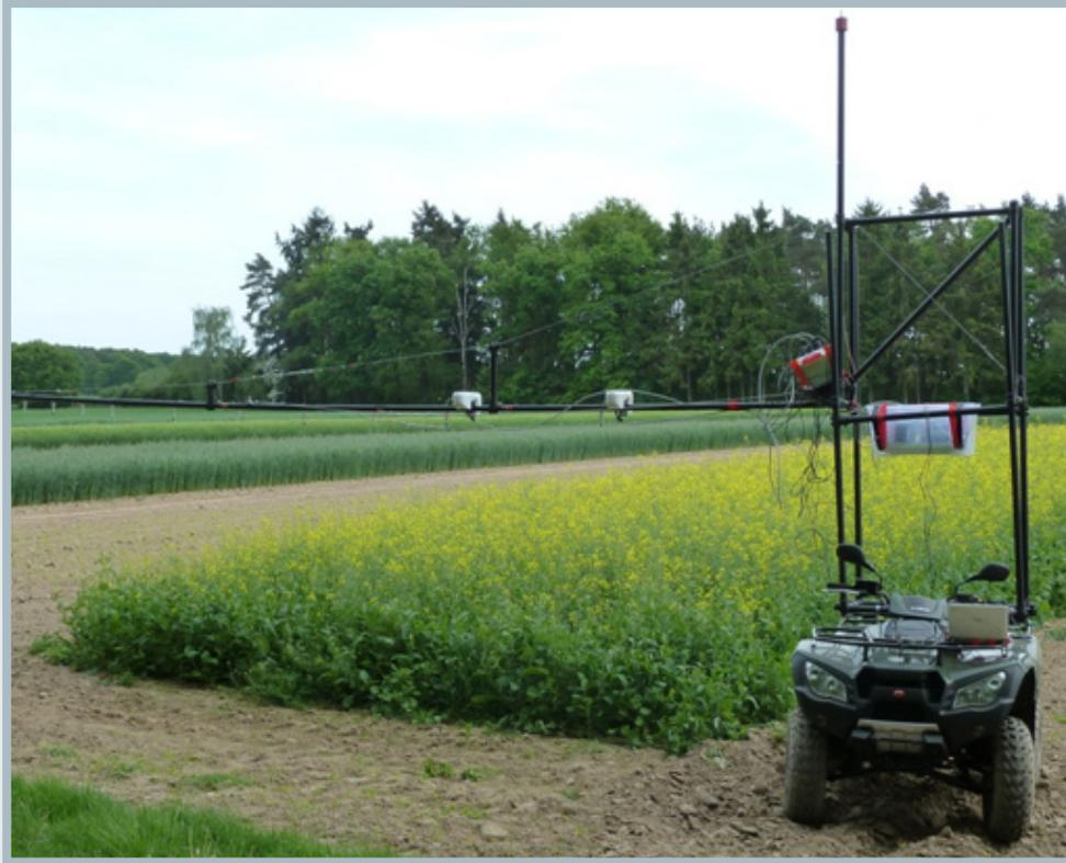
Abb. 2: Quad mit installiertem Tri-Spek System am Standort Braunschweig
