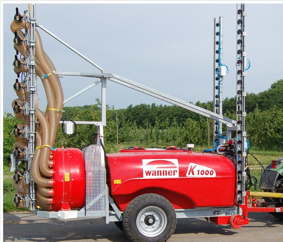
Abb. 1: LADUS Gerät mit montierten IR-Sensoren
