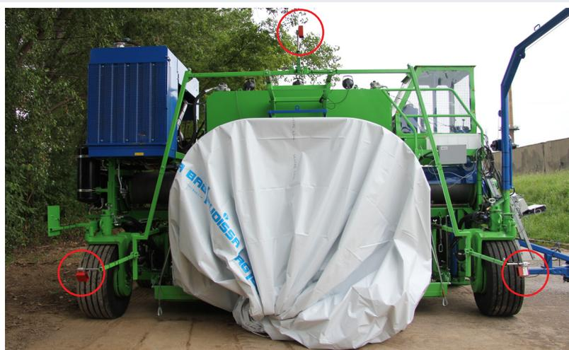
Abb. 1: Aufbau der Halterung und der Abstandssensoren (Kreise) an der modifizierten Siloschlauchpresse
