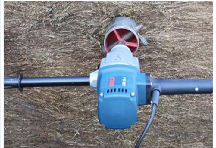
Abb. 2: Beprobungsmuster zur Ermittlung der Dichteverteilung (links), Probenbohrer (rechts)
