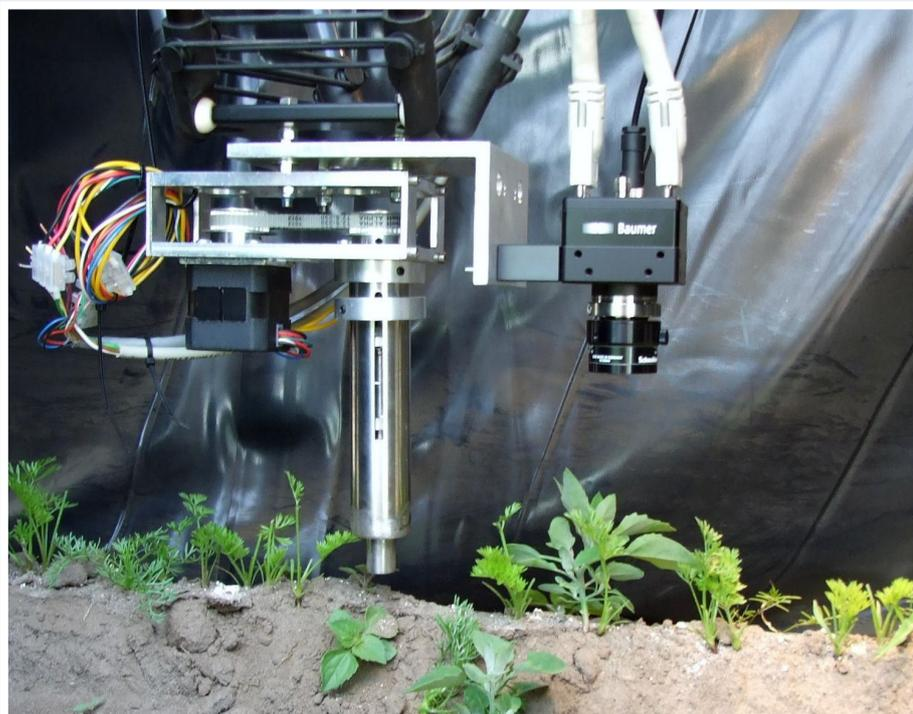
Abb. 2: Manipulator mit Aktor (Hülsenstempel) und Kamera zur Feinjustierung
