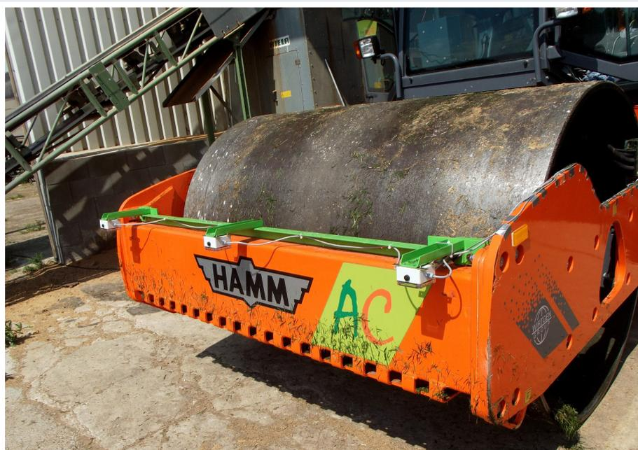
Abb. 3: IR-Abstandssensoren am Verdichter
