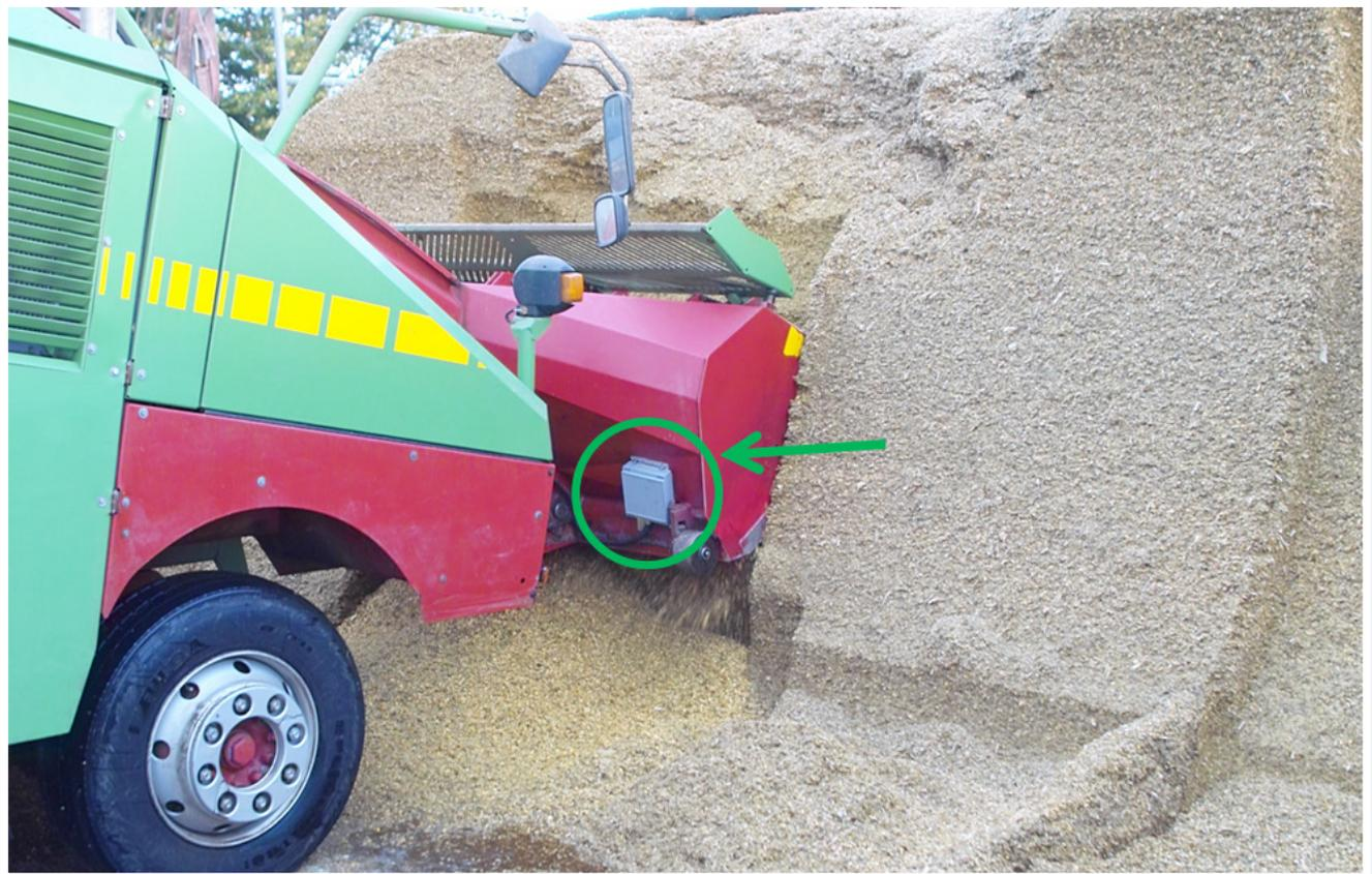
Abb. 1: NIR-Messkopf am Fräsarm des selbstfahrenden Futtermischwagens von Strautmann
